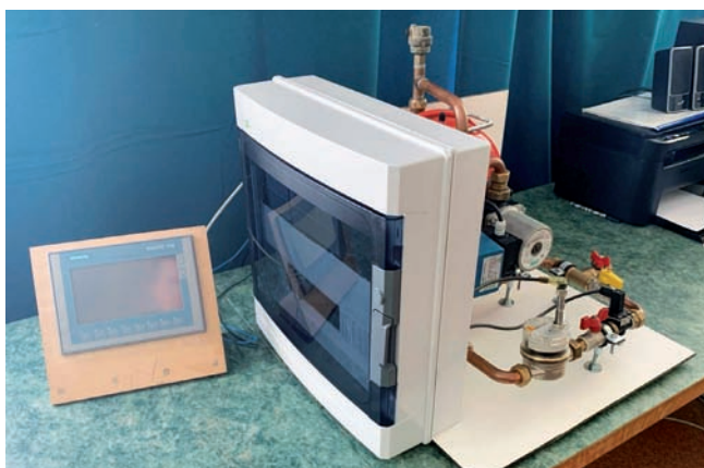
R. Macejka vytvoril automatizovanú meraciu stanicu schopnú samočinne zmerať a graficky znázorniť presnosť vodomerov pri rozličnom prietoku.
